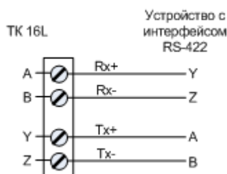
Рисунок 6 Схема подключения RS-422
