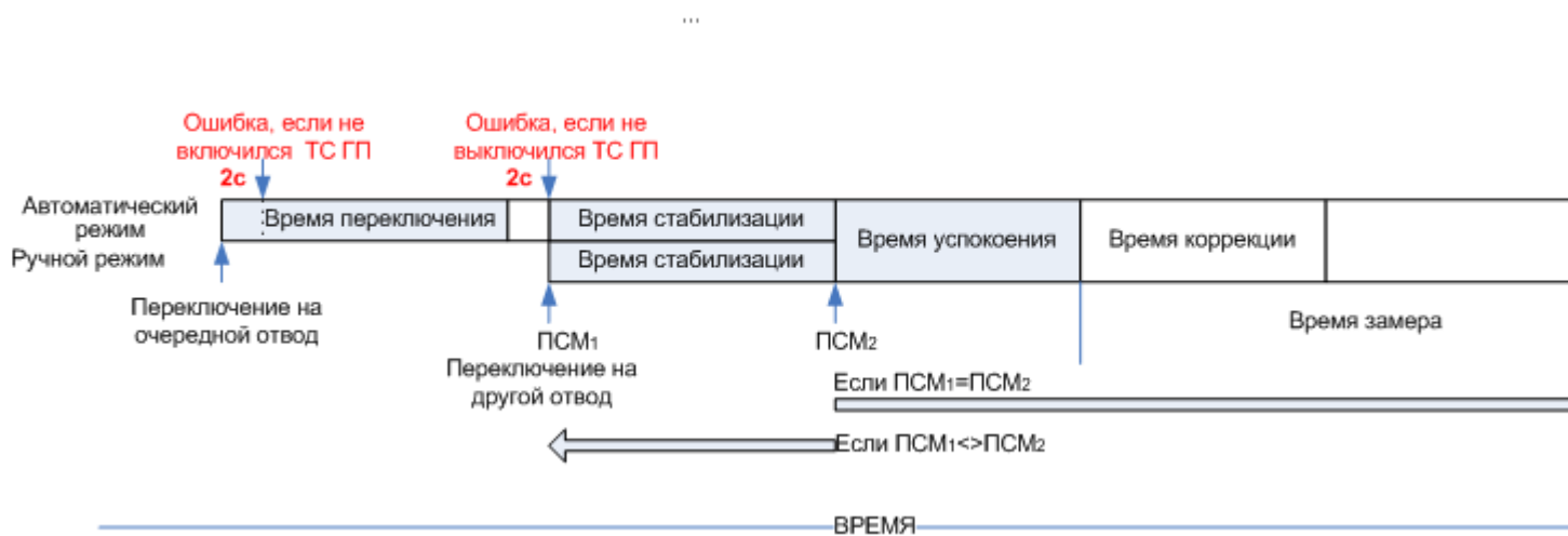
Рис 188. Фазы работы ГЗУ Спутник
