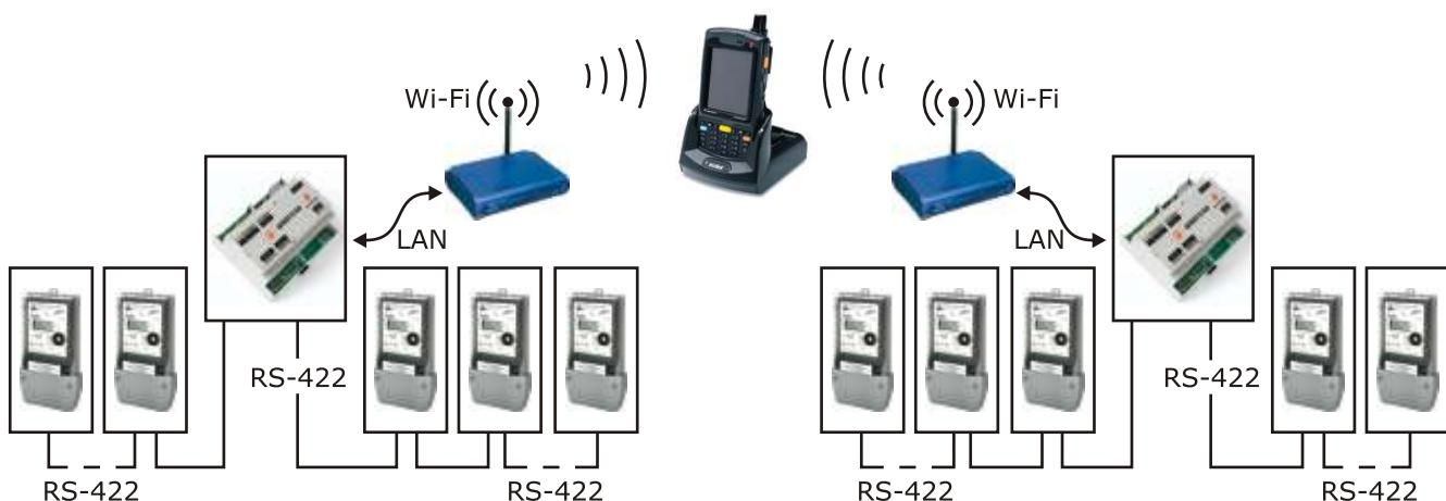
При отсутствии проводных каналов связи можно выполнить ручной сбор данных на КПК. Частота «ручного» сбора данных зависит исключительно от производственной необходимости (полчаса или несколько месяцев). Собранные данные автоматически выгружаются с КПК в системы АИИС КУЭ/АСТУЭ.
