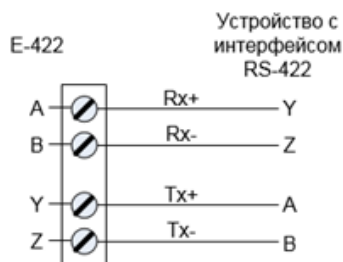
Рисунок 6 Схема подключения RS422
