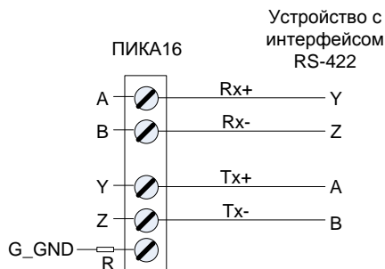
Рисунок 5 Схема подключения к RS-422
