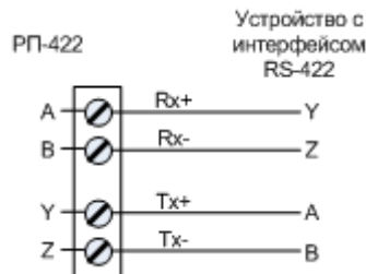
Рисунок 7 Схема подключения RS-422
