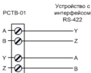
Рисунок 7 Схема подключения RS422
