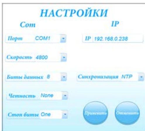
**Настройка параметров подключения РСТВ-01-01 как источника эталонных сигналов:**
