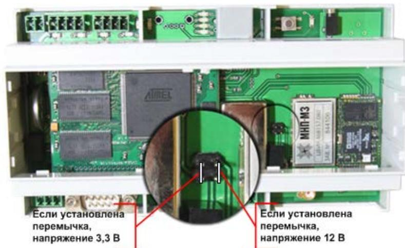
Рисунок 5 Установка технологической перемычки
