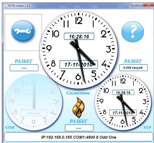
Результаты проверки считают удовлетворительными, если «разбег» времени в режиме автономной работы (при отсутствии сигнала с антенны) за 24 часа составляет не более  $\pm 5$  с.
