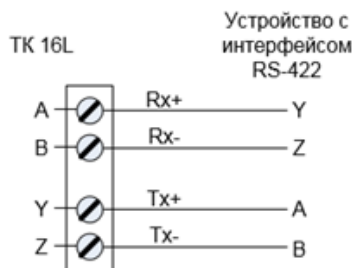
Рисунок 6 Схема подключения RS-422
