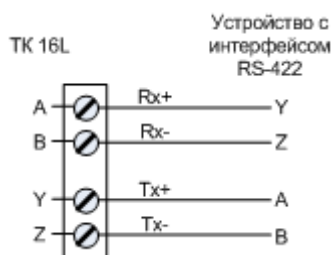
Рисунок 7 Схема подключения RS-422
