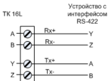
Рисунок 10 Схема подключения RS-422
