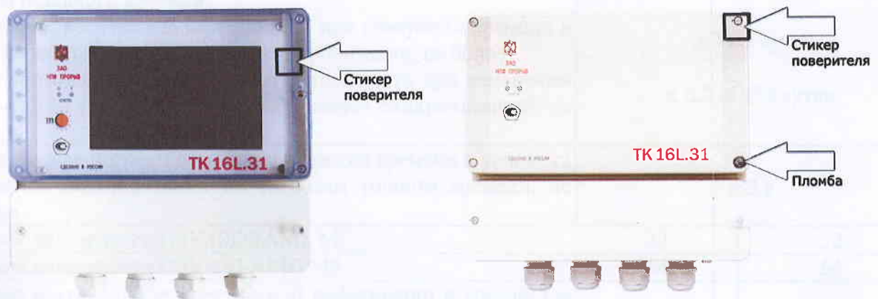
Рис.1 Фото внешнего вида и фото с указанием места клейма о проверке
