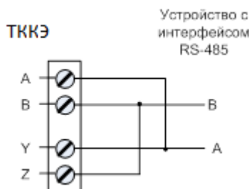
Рисунок 6 Схема подключения RS-485
