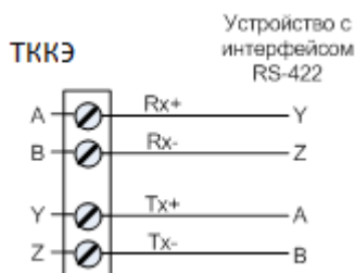
Рисунок 5 Схема подключения RS-422
