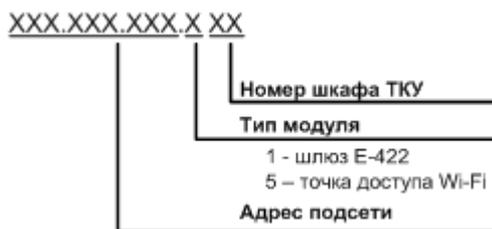
Рисунок 4 Структура IP-адреса модуля
